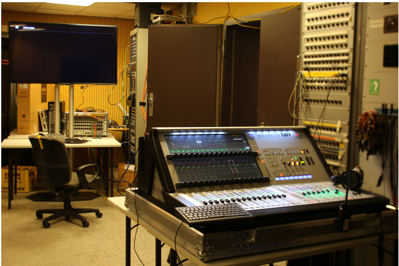
Die Zentrale Audioregie des VOC am 32C3. (Simon Giotta, 2015) Im Vordergrund das Soundcraft Vi1, im Hintergrund Soundcraft Compact Stagebox, Patchpanel und Plasmafernseher. Der Raum ist die Alte Regie.
