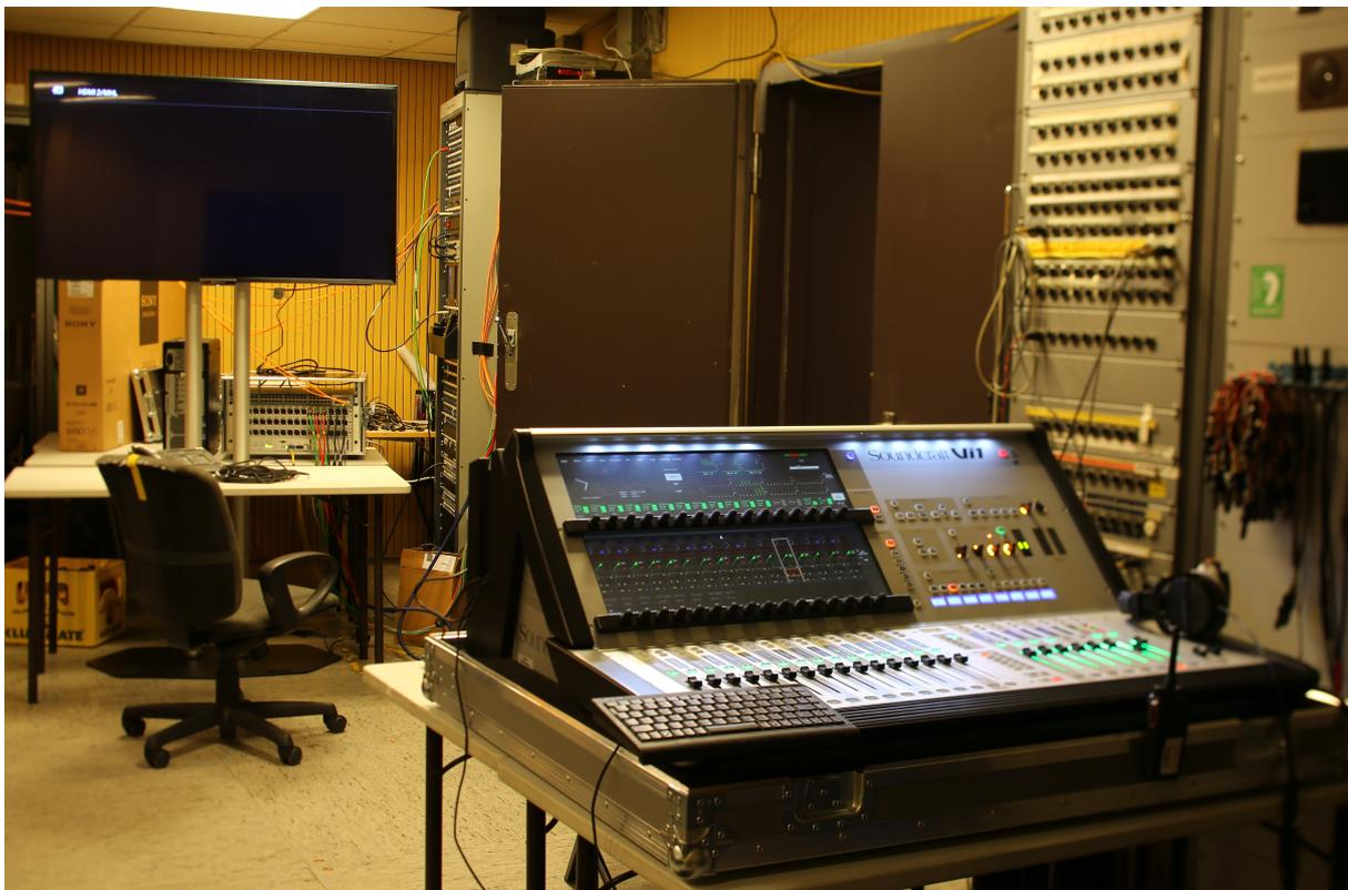
Die Zentrale Audioregie des VOC am 32C3. Im Vordergrund das Soundcraft *Vi1*, im Hintergrund *Soundcraft Compact Stagebox*, Patchpanel und Plasmafernseher. Der Raum ist die Alte Regie.
